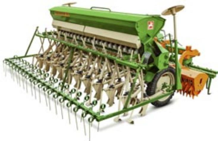
*DIE AMAZONEN-WERKE haben im Laufe ihrer Geschichte einige Weltneuheiten auf den Markt gebracht, wie unter anderem den ersten Dreipunkt-Zweischeibenstreuer, das automatische Fahrgassensystem und die erste moderne Drillkombination der Welt mit einer zapfwellengetriebenen Rüttelegge, einer Packerwalze und einer Drillmaschine in Kombination.*
