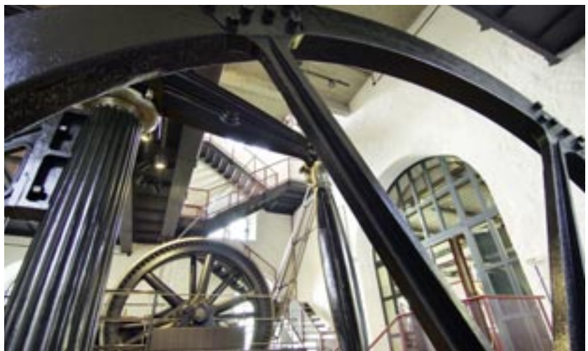
EIN HIGHLIGHT unter den Exponaten im Museum Industriekultur bilden zwei Dampfmaschinen aus den Jahren 1849 und 1916, die in Bewegung gesetzt werden und über Transmissionsriemen historische Maschinen einer Metallwerkstatt antreiben. Foto: Museum Industriekultur
